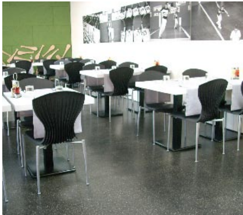
Suelo de bituterrazzo en el restaurante Casa Alcaide del Prat de Llobregat, en Barcelona
